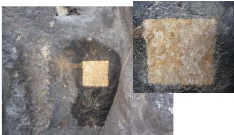
Figure 2 : Illustration des essais sur des parties très altérées. Vue générale et détail : localisation du prélèvement effectué (cadre vert)
