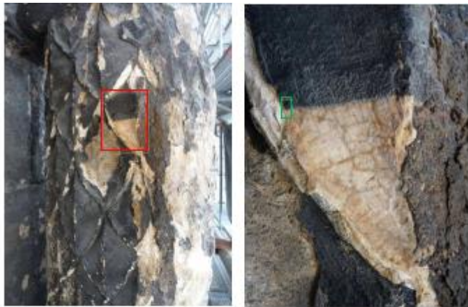
Figure 2 : Illustration des essais sur des parties très altérées. Vue générale et détail : localisation du prélèvement effectué (cadre vert)
